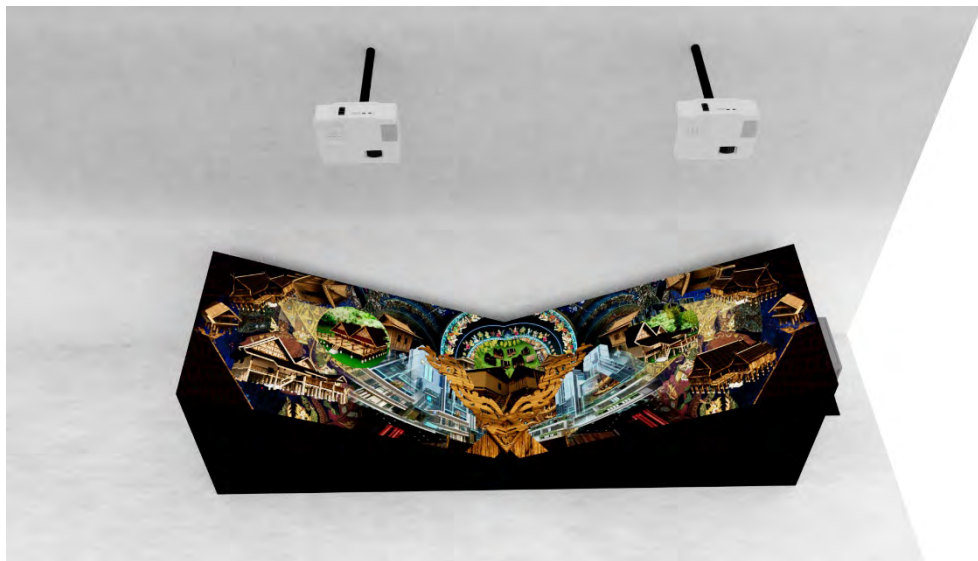
ภาพที่ 3.29 ภาพแสดงระบบโปรเจ็กเตอร์ที่ติดตั้งเหนือจอร์ับภาพรูปตัววี สำหรับฉายภาพลงบนพื้นผิวเอียงของจอ
