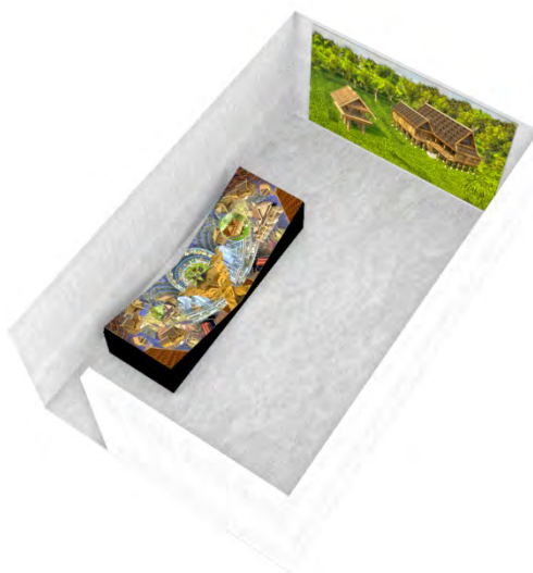
ภาพที่ 3.23 การวางจอร์ับภาพรูปตัววี บริเวณทางเข้าของห้องนิทรรศการ โดยมีจอภาพหลักสำหรับฉายภาพบ้านล้านนาอยู่ที่ผนังด้านในของห้อง
